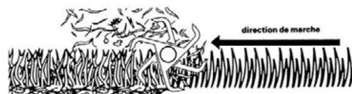
Régler le scarificateur pour griffer le sol sur 2 à 3 cm de profondeur.
