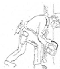
**Trait supérieur** : oblique suivant un angle de 60° à 80° et ne dépassant pas le 1/3 du diamètre de l'arbre. Le point de chute de l'arbre est visé avec les lignes de visée de la tronçonneuse (repères sur le capot de la tronçonneuse ou à l'aide de la poignée).
