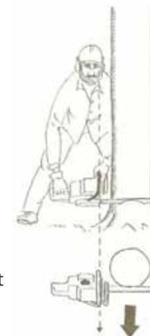
**Entaille inférieure** : de façon à ce qu'elle coïncide exactement avec l'entaille supérieure.
