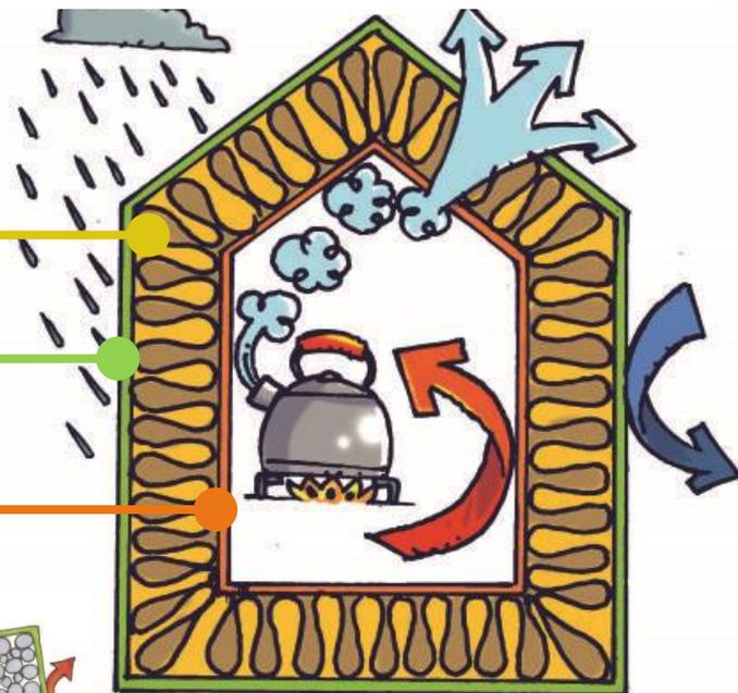
Rendre l'isolant étanche à l'air, au vent et à la pluie sur toutes ses faces et réguler le passage de la vapeur d'eau.
