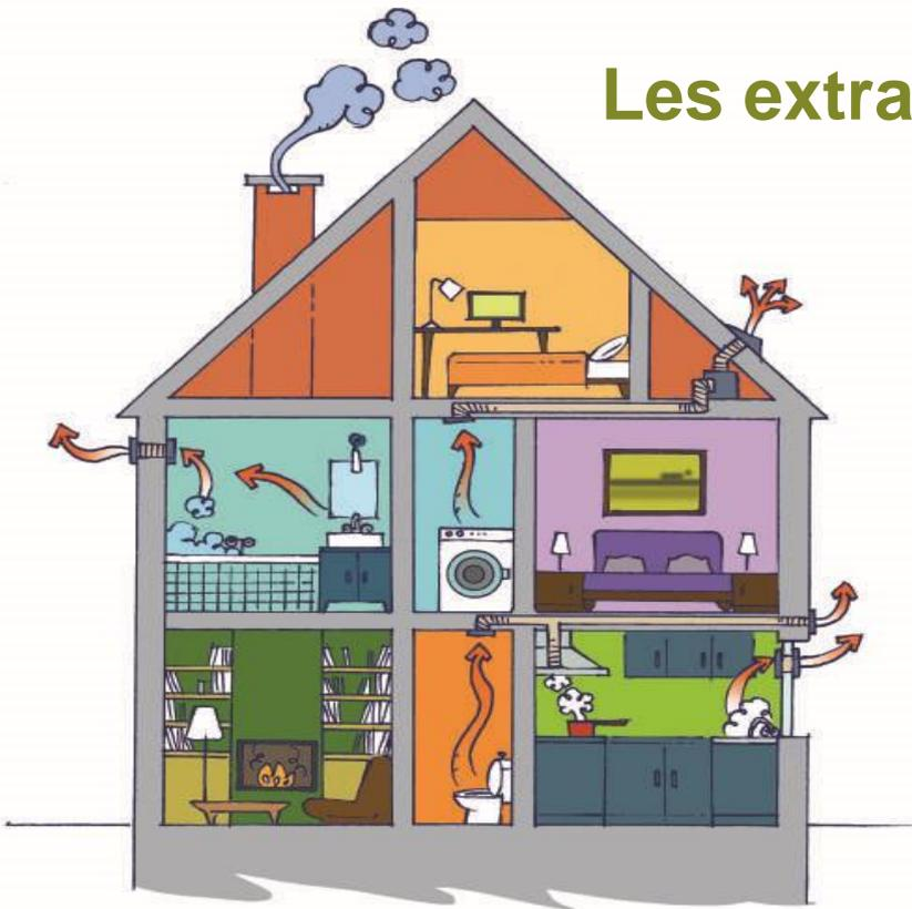
Evacuent l'air humide d'une pièce directement à l'extérieur ou via un conduit indépendant
